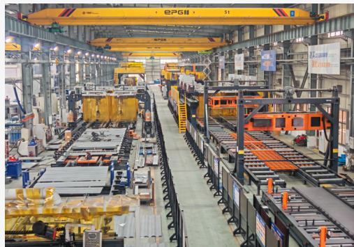
▲ 自動化焊接產線
